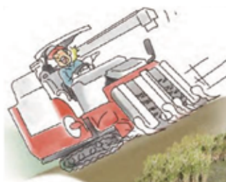
バック走行時の転落
