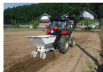
写真3 もみ殻簡易暗渠施工
