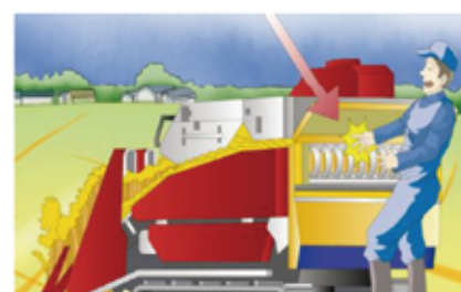
藁詰まり除去時の巻き込まれ
