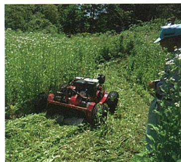
写真1 雑草地进行する リモコン式自走除草機
