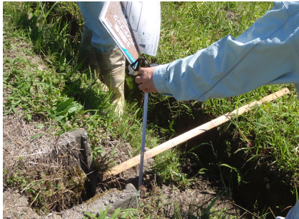
落水口底面までの落差確認
