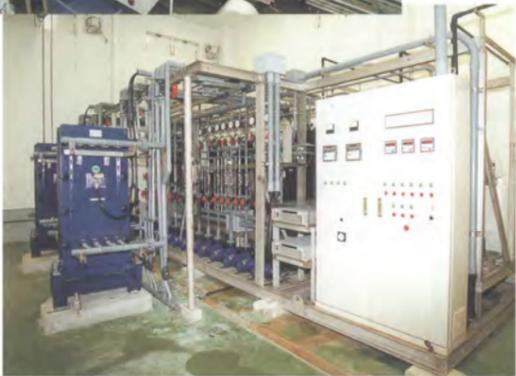
深層水を「淡水」「濃縮水」「ミネラル濃縮水」に分離する「多段式イオン交換電機透析装置」(下)。濃縮水やミネラル濃縮水を化粧品やミネラルウォーターなどに活用する。(深層水を使った製品開発に積極的な県内の企業)
