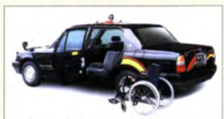
後部座席を回転させて、車いすからラクに乗り込むことができる福祉タクシー。
