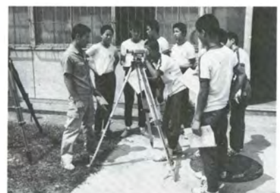
「見える、見える。」(レベルによる土地の高さの測り方)
