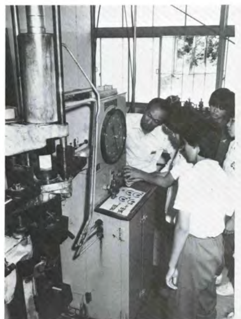
「木材って何んて強いのか」(木材の圧縮強度測定、福野高校)
