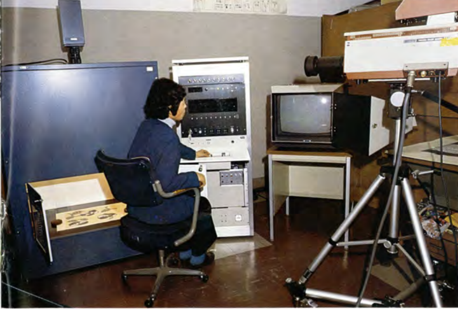
織維デザインの配色替え研究をする装置(自動配色装置)
