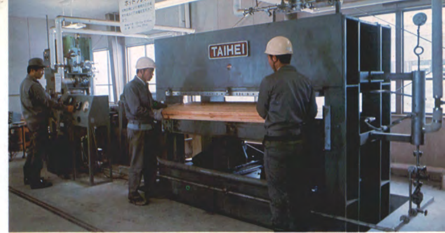
単板・合板または削片を積層接着して合板または削片板にするホップレスの試験
