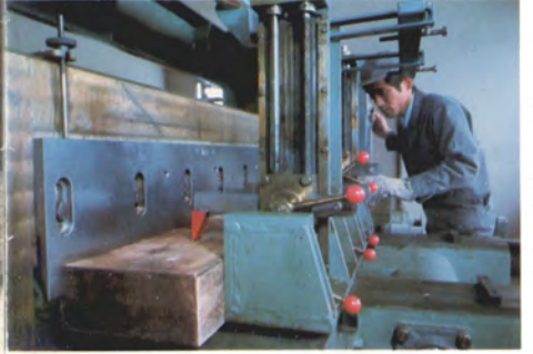
木材の欠点を分散させた集成材(シベリヤ産カラマツ3径×10径角)を実大強度試験機(20t)にかけてその強さをはかり16tの重さで折れた瞬間 同じカラマツの柱材の1.6倍強である
