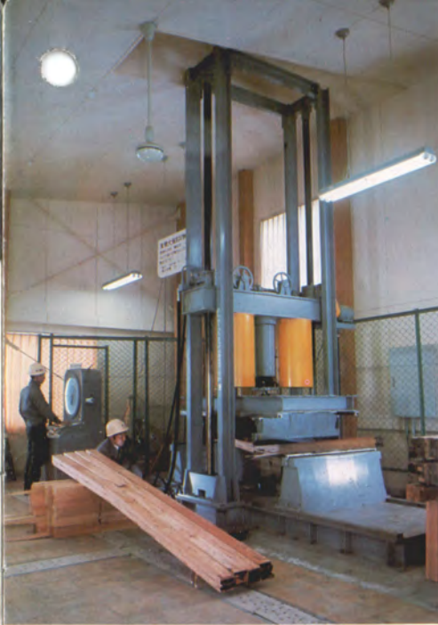
木材の欠点を分散させた集成材(シベリヤ産カラマツ3径×10径角)を実大強度試験機(20t)にかけてその強さをはかり16tの重さで折れた瞬間 同じカラマツの柱材の1.6倍強である
