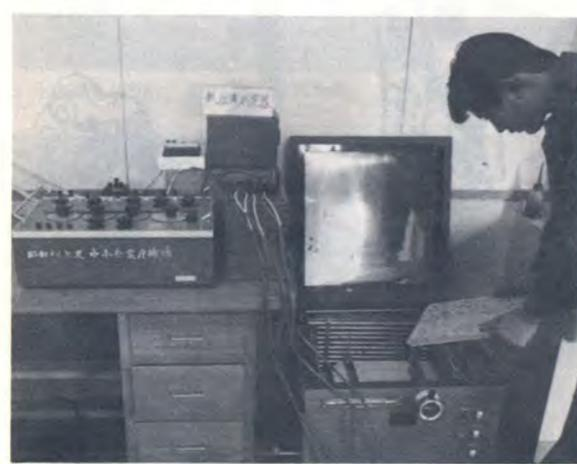
低質材を活用した板の熱伝導率を測定実験するところ
