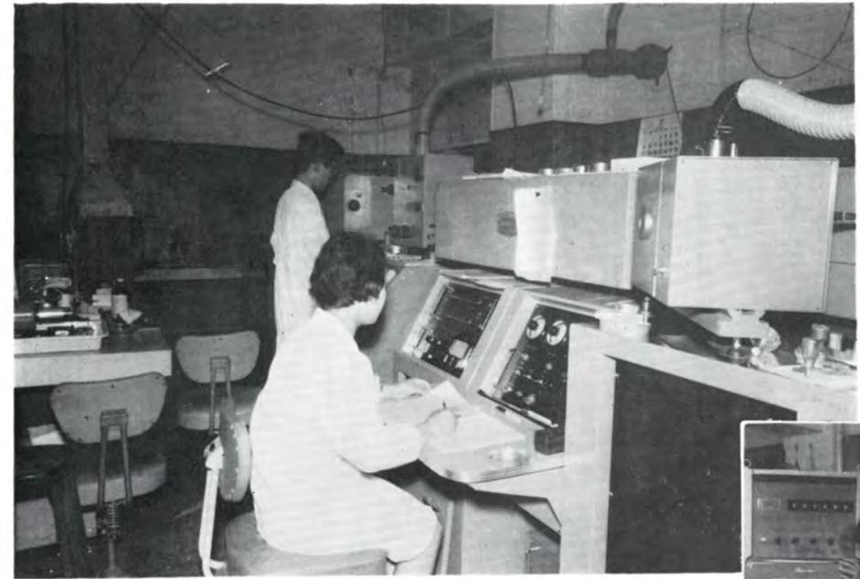
▲光電測光式発光分光分析装置…アルミニウムや銅合金の成分を分析し 品質向上をめざす新鋭機
