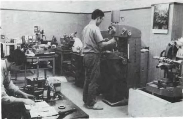
▲精密測定室…恒温恒室 $20 \pm 1$ 度 湿度 $50\% \pm 1\%$ に調節し 心円度の測定などを行なっている
