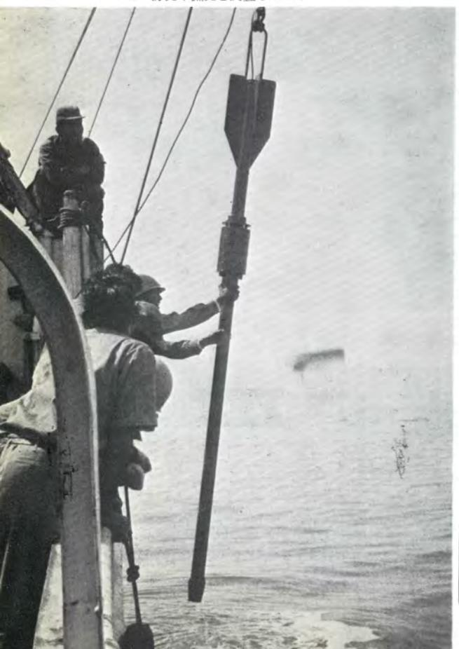
▼汚濁水連続記録装置……富丸にとりつけられた新鋭機 水温 水質 濁度を航行しながら測定できる
