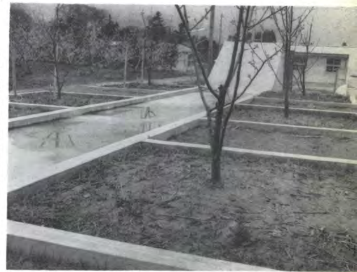
果樹ライシメーター…コンクリート枠で仕切って、養分溶肥試験を行なっている。
