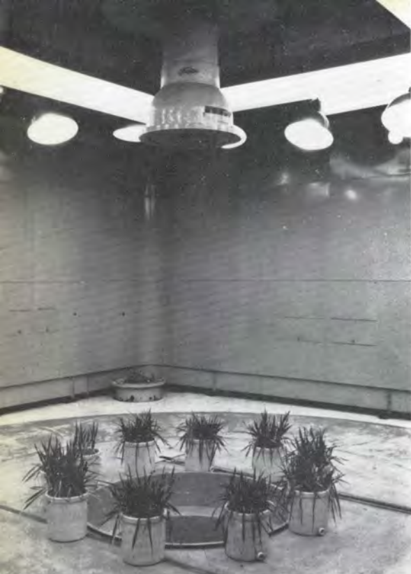
ガンマー線照射室内部……アイソトープ利用によって新品種の育成をめざす。
