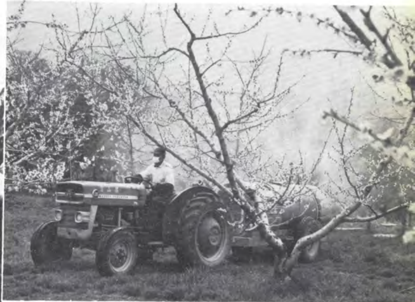
機械導入によって省力化を進めるため、スピードスプレーヤーによる果樹園の薬剤散布
