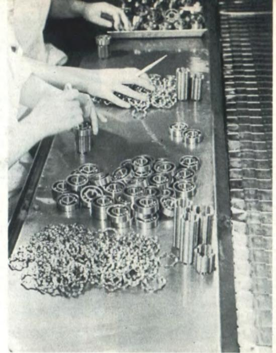
機械製造工業（ボールベアリングの組立）
