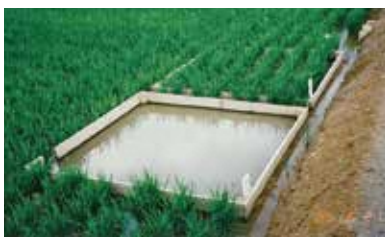
調査観測区調査（木枠調査） 土壌が移動しないように木枠を設置し、3年間の調査を行う。木枠2個のうち1個には水稻を作付けせず、水稻によるカドミウムの吸収がない場合の土壌のカドミウム変化も調査する。
