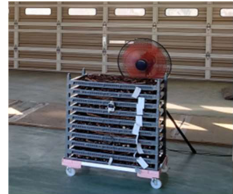
生産者施設における網皿(せいろ)での乾燥試験状況
