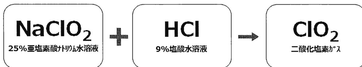
図1. 二酸化塩素生成の反応式
