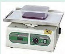
シーソー様に振とうする装置。ゲルの染色やウェスタンブロットング時のメンブレンの抗体反応や洗浄に使用する。
