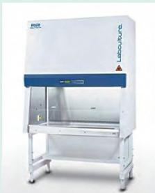
Class II安全キャビネットは、病原体や遺伝子組み換え生物等のバイオハザードを封じ込める実験設備に加え、埃や雑菌の混入を防いで無菌状態での作業を可能にしたもの。
