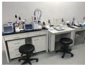
マイクロ/セミマイクロ天秤、カールフィッシャー水分計(容量/電量滴定法)を設置
