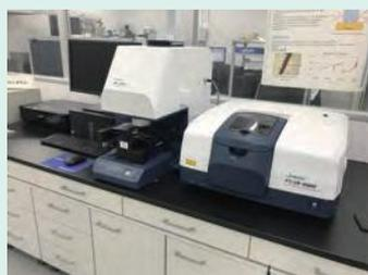
試料表面の赤外吸収スペクトルを測定し、構造を解析。顕微鏡下で測定部分を選択し、微小な付着物等の分析が可能。ATR法、透過法、反射法での測定が可能。
