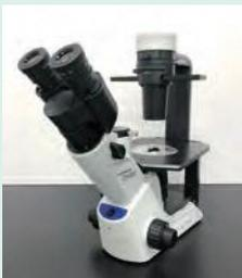
培養細胞及び採取した細胞の形態観察に用いる。
