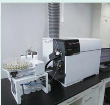
**装置の概要** 分子を元素に分解し、各元素の質量を検出することで、試料に含まれる微量元素の濃度を評価する装置。
