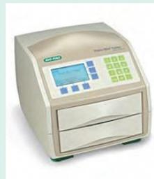
電気泳動後のゲル中の試料をメンブレン上に移行させるための装置。タンパク解析の手法であるウェスタンブロットングに用いる。
