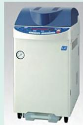
高温高圧の蒸気を内部に飽和させることができる装置。実験器具等の滅菌処理に用いる。
