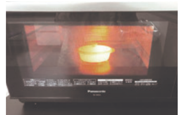
加熱後3分12秒で容器へ燃え移る
