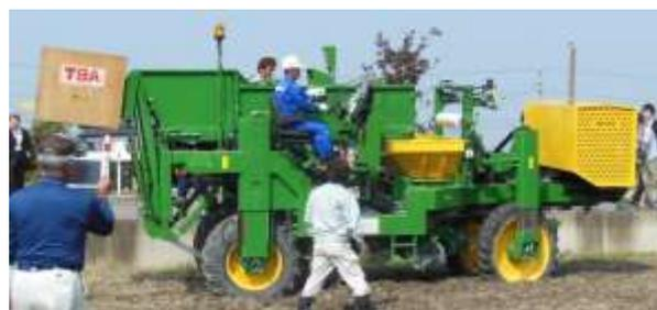
写真1 オランダ製の球根植込・収穫ロボット
