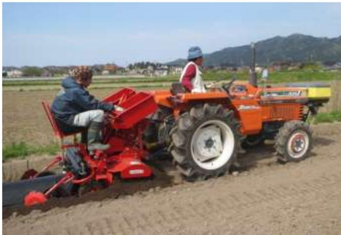
うね成型・植付け・マルチ同時作業機
