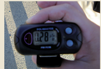
携帯した線量計（写真は 0.28 μSv/h）
