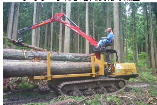
フォワーダによる間伐材の搬出
