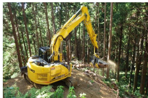
ハーベスタによる造材作業状況
