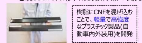
樹脂にCNFを混ぜ込むことで、**軽量で高強度なプラスチック製品**(自動車内外装用)を開発
