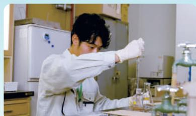
試薬を用いて水生生物が生育するために重要な海水中の溶存酸素量を測定しています。
