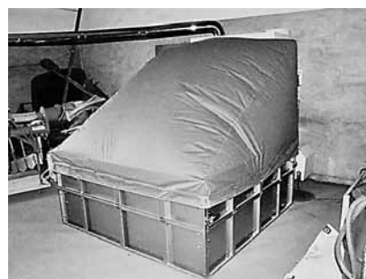
図2 改良された平型乾燥機（幌状シート使用時）
