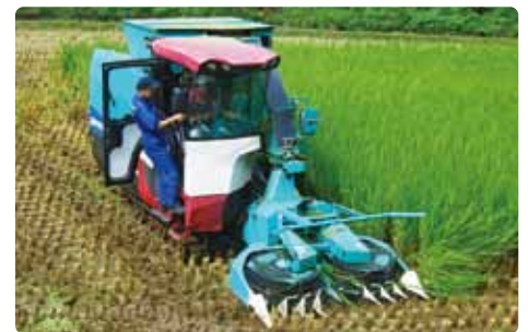
微細断型ロールベラーによる 稲WCS専用品種の収穫(富山市)
